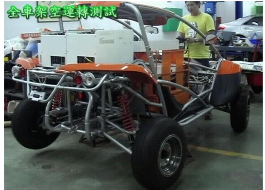
全車架空運轉測試與落地測試
